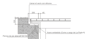
Diagrama detallado de apoyo superior e inferior (de simetría a)
