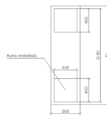
Diagrama detallado de apoyo intermedio (Visto en planta)
